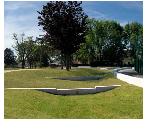
Dispositifs de micro-stockages temporaires, topographie artificielle associée (creux, vallonements, pentes...), et franchissements associés
